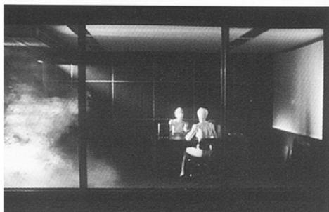
*Déflexion du courant d'air au plancher*
